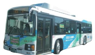
天然ガスを燃料とするバス。従来のディーゼルバスに比べ、NOx(窒素酸化物)を80%、CO(一酸化炭素)を50%、HC(炭化水素)を80%、PM(粒子状物質)を100%削減することができます。
