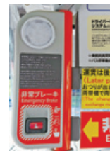
非常停止ボタン
