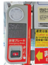
非常停止ボタン
